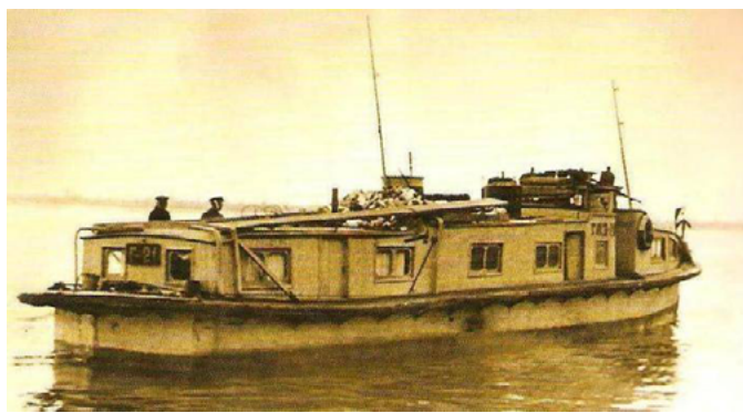
Мобилизованный газогенераторный буксир Г-21
